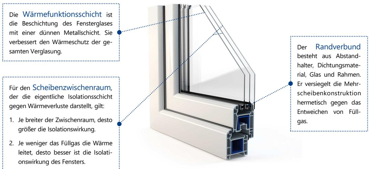
Veraltete Abstandhalter aus Aluminium sind stark wärmeleitend und führen oft zu Kondenswasser in Rahmennähe. Zeitgemäße Abstandhalter, oft als »warme Kante« bezeichnet, werden aus geeigneteren Materialien gefertigt und verbessern den U-Wert des Fensters um ca. 10%.
