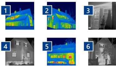
Ihre Infrarotbilder zeigen, dass im Bereich des Daches ungleichmäßige Oberflächentemperaturen festgestellt wurden. Anscheinend besteht die Notwendigkeit die Wärmedämmung des Daches zu verbessern, um zukünftig Energie einzusparen. Im Folgenden werden Ihnen verschiedene Möglichkeiten einer nachträglichen Dämmung im Dachbereich aufgezeigt.
