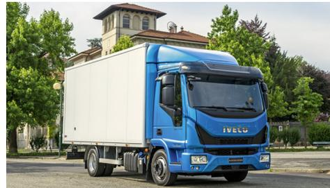
Iveco setzt sich für die Förderung alternativer Kraftstoffe ein. Seinen neuen Eurocargo bietet der europäische Marktführer im Bereich Erdgas-Nutzfahrzeuge daher auch in einer „Super-Eco“-Version mit Erdgas-Antrieb an. Der Eurocargo Natural Power verfügt in der Erdgas-Variante über einen 6-Zylindermotor mit 204 PS. Das Modell gibt es in den Gewichtsvarianten von 11 bis 16 Tonnen. Mit 75 Kilogramm Erdgas im Tank kann der Eurocargo
