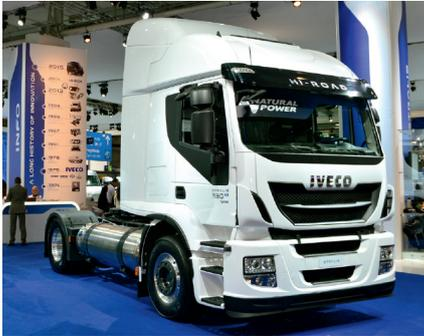
Abb. 21: Die Zugmaschine IVECO Stralis ermöglicht den Betrieb mit LNG und CNG.
