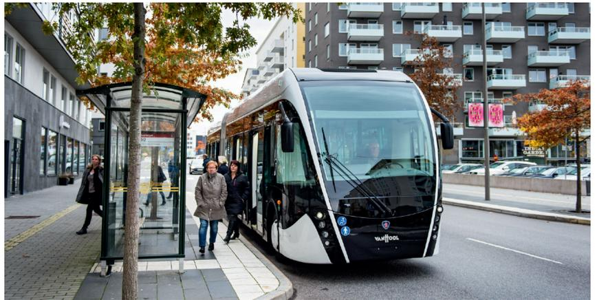
Abb. 22: Buskonzept Exqui.City von Scania und Van Hool mit Erdgasantrieb (Quelle: Scania).
